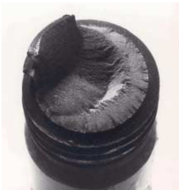
Abbildung 2: Ermüdungsbruchfläche einer Schraube unter überwiegender Axialbeanspruchung [2]
